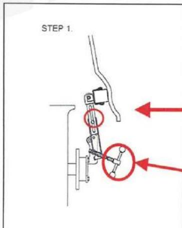
フェンダー折り曲げ機を車輛のハブボルトに取り付け、ハブナット又は、ハブボルトで固定して下さい。
