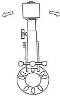
ヒートガンで車輛の修正部の塗装を十分に暖めて、ローラーを左右に動かし、フェンダーの修正を行って下さい。
