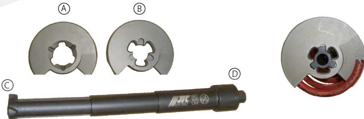
6. ディスクとメインスピンドルが正しく取り付けられた事を確認してください。特に C 部の引っ掛け部がディスクの溝に正しく入っているか、またディスクの内側にコイルスプリングが正しく収まっているか確認してください。
