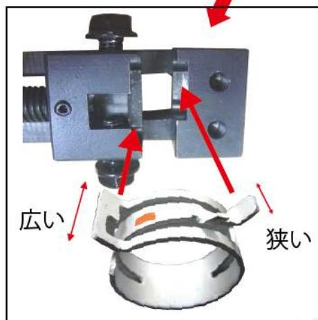
①車両のホースバンドに JTC4212 をセットする際、周りに干渉する場合は プライヤー等で干渉しない位置にずらして JTC4212 をセットして下さい。
