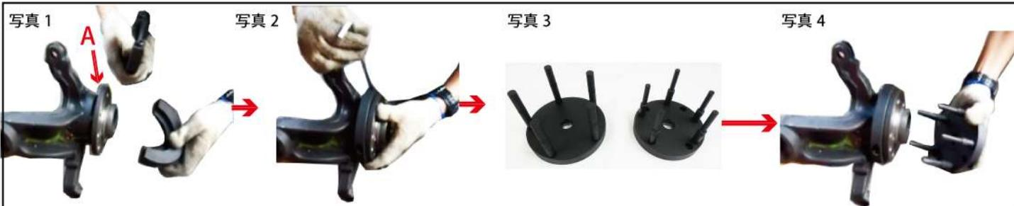
1. ハブベアリングのディスクに適合する②～⑤の黒色のアダプターをディスクとハブの隙間 (A) にセットして (写真 1) 取付ボルト⑯で固定します。 (写真 2)
