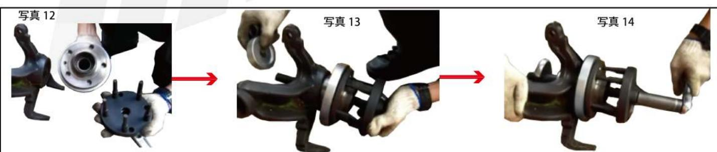
2. ホイールボルト取付穴に適合するセンターディスクとピン⑫～⑯を組み合わせます。 (写真 12)
