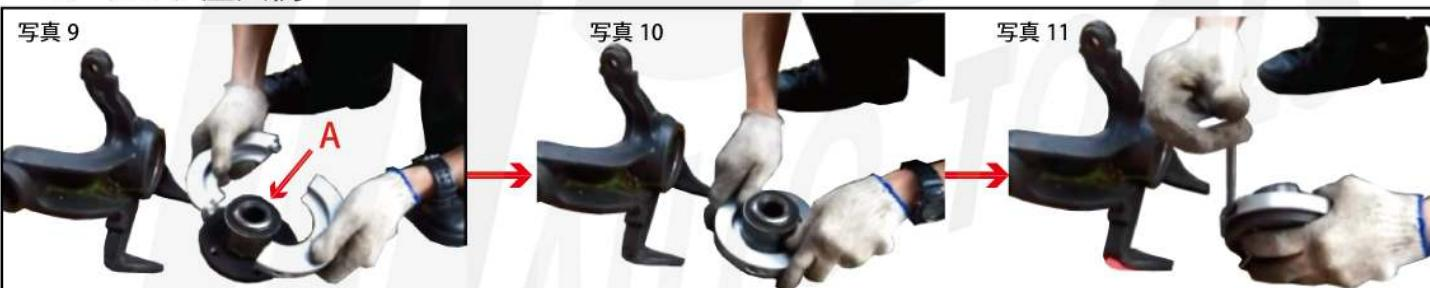
1. 新品のハブベアリングのディスクに適合する②～⑤の銀色のアダプターをディスクとハブベアリングブの隙間 (A) にセットして取付ボルト⑯で固定します。 (写真 9.10.11)
