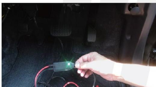
通常キーシリンダーからキーを抜いて（図10）のように車両のOBDIIコネクター（オス）とOBDIIワニ口コード（メス）の本体を接続するとコネクターの通電チェックのLEDランプが点灯します。（図11）
