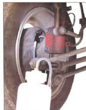
ブレーキキャリパーのニップルに先端のゴムを取り付けニップルを緩めてブレーキペダルを踏みブレーキフルードを排出します。
