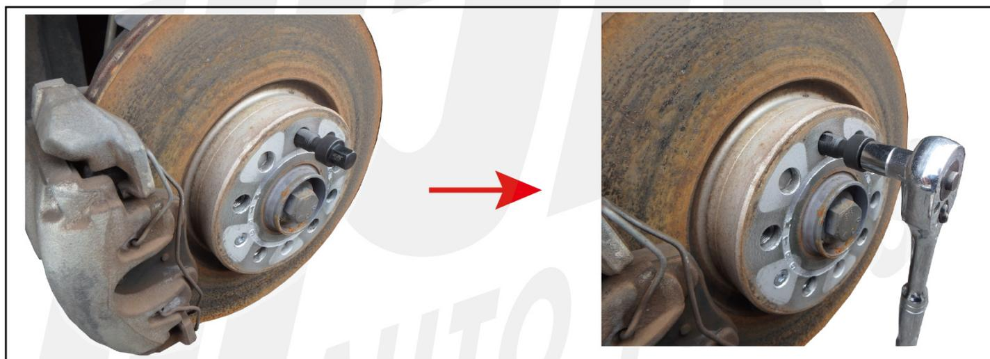
修正したいハブ穴のネジサイズと同じタップを選び、ネジ山部分に浸透剤等を塗布しタップを真直ぐセットしてメガネレンチ・ソケットを使用し締め方向・緩め方向に少しずつ交互に回し、修正して下さい。
