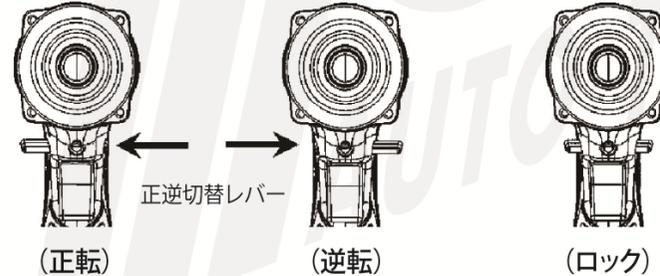
正逆切替レバーを操作することにより回転方向が切り替えられます。レバーを中央の位置にするとトリガースイッチをロックする事が出来ます。使用しない時は、レバーを中央の位置にして下さい。
